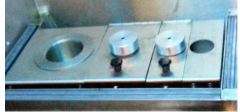
Dettaglio - Stazione di lavoro con pozzetto del calibratore di dose
