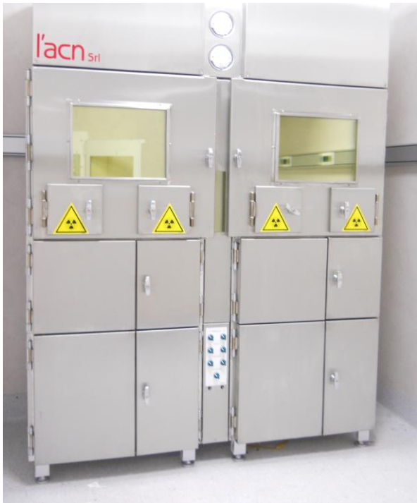
Esempio di realizzazione - gammaCell-TWIN installata in un locale adibito a camera calda
